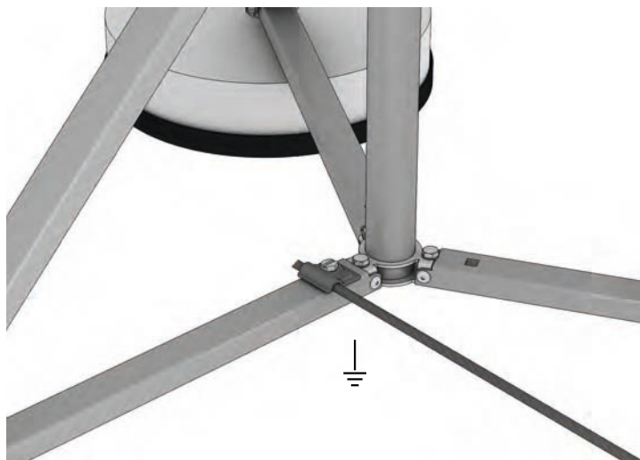
Slika 32 Spoj za izjednačenje potencijala kod izolirane hvataljke
