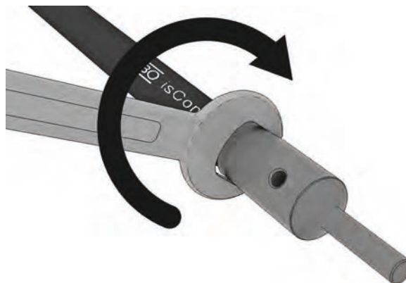
Slika 13 Učvršćivanje priključnog elementa zavrtnjem
