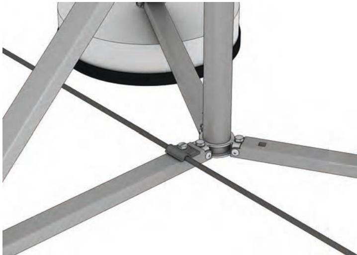
Slika 33 Spajanje neizolirane hvataljke na sustav za zaštitu od udara munje
