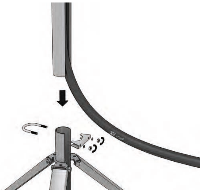
Slika 34 Spajanje potporne cijevi s tronošcem
