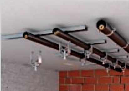
Montaža na strop pomoću odstojne obujmice i BBS obujmice.
