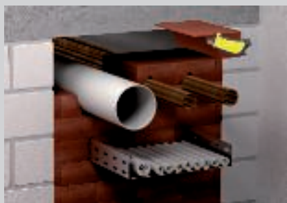
Provođenje gorivih cijevi bez dodatnih mjera zaštite.
