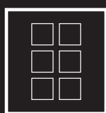
6 x Modul 45 Vanjska dimenzija 222x222mm
